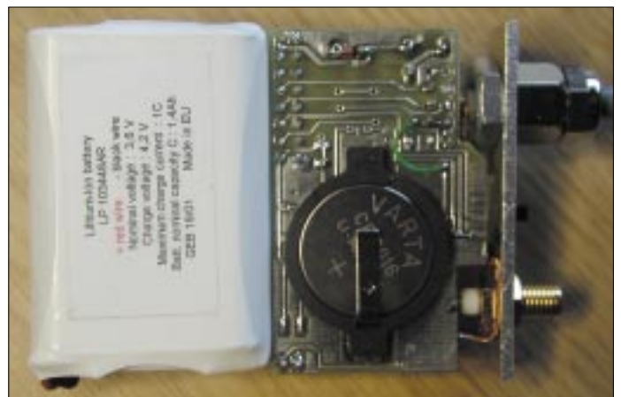
Bild 4: Doppelstöckiger Aufbau der GPS-RX Platinen
