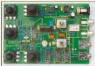
Der 80-/140-m-QRP-Sender enthält fast keine Spulen und ist daher leicht nachzubauen. Foto: DJ8IL
