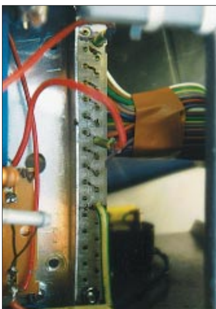
Bild 2: An der Buchsenseite eines zweireihigen Steckverbinders sind alle Spulenanschlüsse zugänglich. Fotos: DL7HG
