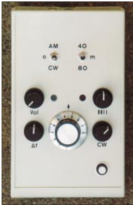
Bild 1: „Start-TX“ im Gehäuse Bopla-BP810. Zwischen den Reglern für Lautstärke und Gewicht erkennt man Elektret-Mikrofon und Mehrzweck-LED. Die Platine ist an den Schaltern S1, S2 sowie an den Potentiometern P2 und P3 mit der Gehäusefront verschraubt.
