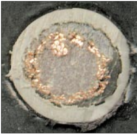
Bild 7: Ein Koaxialkabel, das vor zwei Jahren die Ilmenauer ärgerte. Mal arbeitete es zufriedenstellend, dann gab es es einen Schluß, der nicht im Stecker, sondern beim Öffnen des Kabels gefunden wurde. Der „mittige“ Innenleiter war auf Wanderschaft gegangen und berührte von Zeit zu Zeit (wärmeabhängig) den Außenleiter, was keinerlei Freude auslöste!
