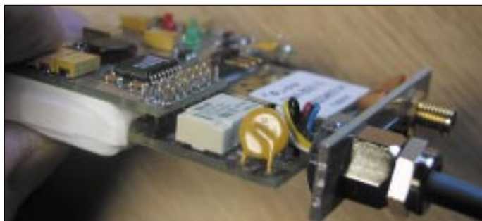
Bild 4: Doppelstöckiger Aufbau der GPS-RX Platinen
